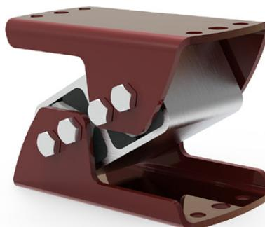
Die Motorwippe ist für Friktionsriemenantriebe von 7.5- bis 45-kW-Motoren konzipiert. Sie lässt sich stufenlos einstellen und garantiert damit eine optimale Riemenspannung. Sie ist mit zwei integrierten Achsabstützungen, robusten und wartungsfreien Vorspanneinheiten und einer Schraubkopfhalterung für eine einfache und sichere Montage ausgestattet.
